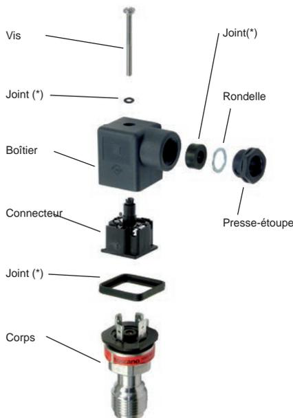
(\* ) Ces éléments sont essentiels pour garantir l'étanchéité du dispositif (IP65).
